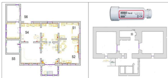
Fig. 4.1. Localizarea senzorilor la nivelul superior (S1, S2, S4, S5, S6) și la nivelul inferior (S3)
